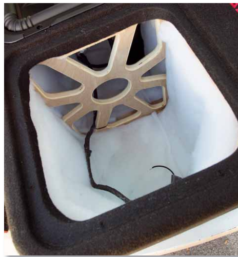
Liebe zum Detail, auch wenn man's nicht sieht: Die Versteifungen sind den L7-Membranen nachempfunden
