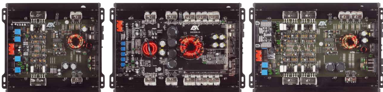
Der Mono-Endstufe (Mitte) sieht man an, dass sie ein Stück teurer ist als die Mehrkanaler. Zweikanal- und Vierkanalendstufe haben gleich aufgebaute Verstärkerzüge
