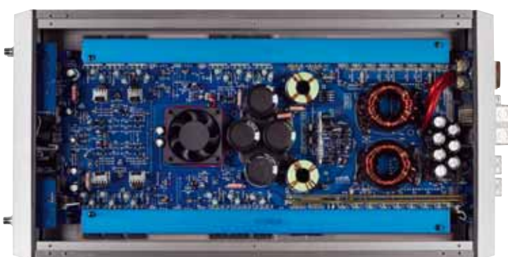
Alle drei, auch die Monoendstufe X4 Atlas, sind als Class-A/B-Verstärker konzipiert, der Materialeinsatz ist beachtlich
