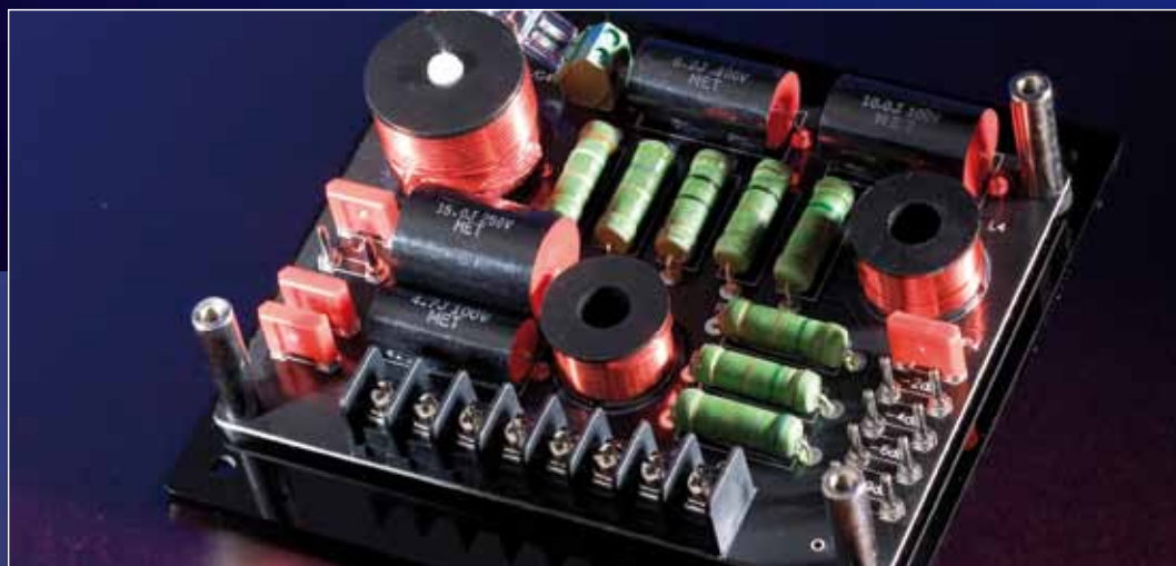
Vorbild: Alle Bauteile der Frequenzweiche wie die Luftspulen, die Folienkondensatoren, die Metalloxyd-Widerstände und die stabilen Jumper sind erste Sähne.
