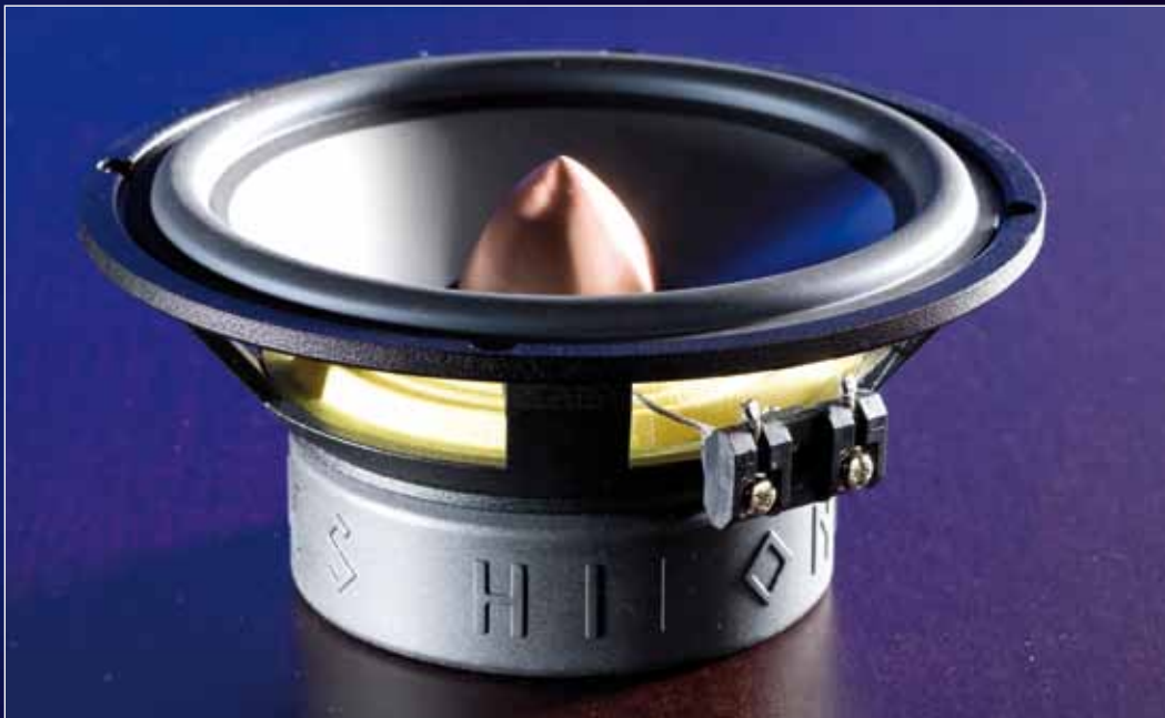
Im Mittelpunkt: Der massive Phase-Plug aus Kupfer sieht nicht nur glänzend aus, er fördert auch die Kühlung der Schwingspule und reduziert zudem Verzerrungen (Klirr) des Antriebs.
